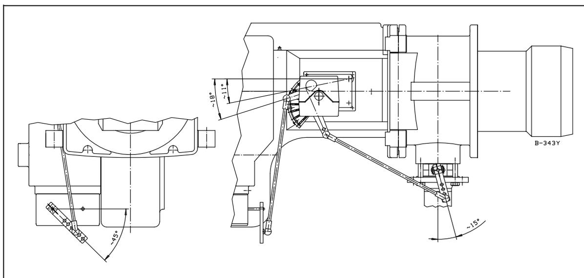
Положения рычагов на рисунке являются условными. По необходимости они могут быть изменены, напр. в зависимости от производительности горелки, типа котла, рода газа.
