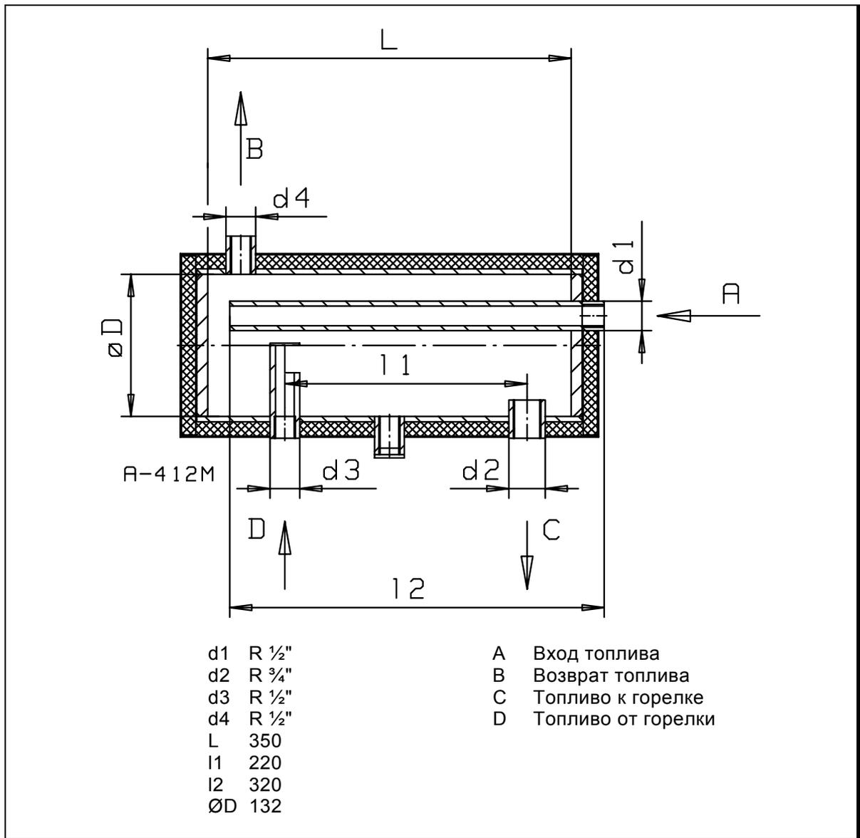
При монтаже деаэратора, предназначенного для удаления газа и воздуха из топлива, необходимо учитывать правильное направление течения топлива.
