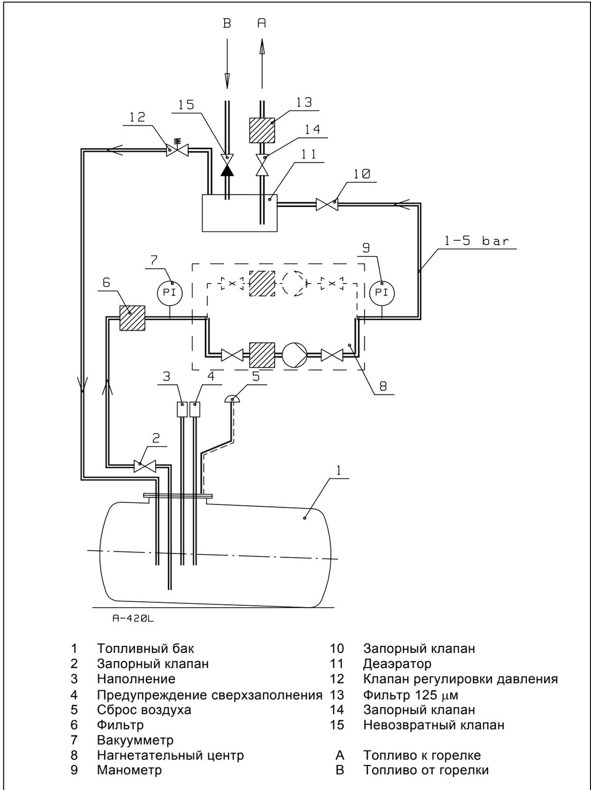
Производительность нагнетательного центра должна быть на 200 кг/ч выше сжигаемого количества топлива. Например: мощность горелки имеется 200 кг/ч => производительность нагнетательного центра составляет ок. 400 кг/ч.
