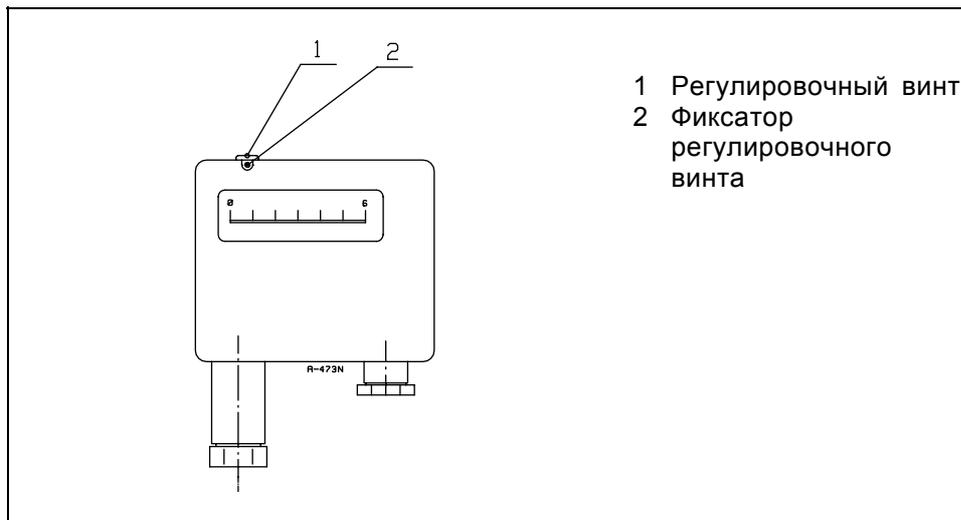
Реле давления топлива (макс.) контролирует давление топлива в возвратной трубе. Если давление превышает заданное значение, горелка останавливается. Реле настроено на заводе-изготовителе (6 бар).
