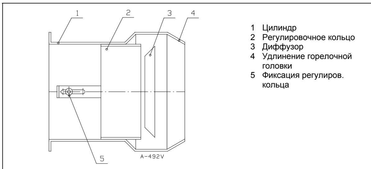
**Вним!** При поочередной работе на обоих видах топлива, положение регулировочного кольца устанавливается для жидкого топлива. Если место кольца относительно диффузора меняется, также скорость и расход воздуха меняются. Проверьте результат сжигания анализом дымовых газов и подрегулируйте подачу воздуха.
