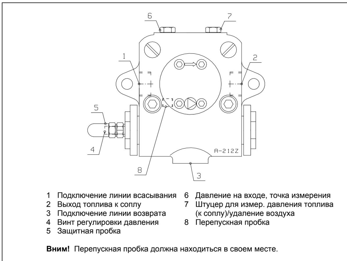
Давление топлива на входе в насос: 1 - 5 бар
